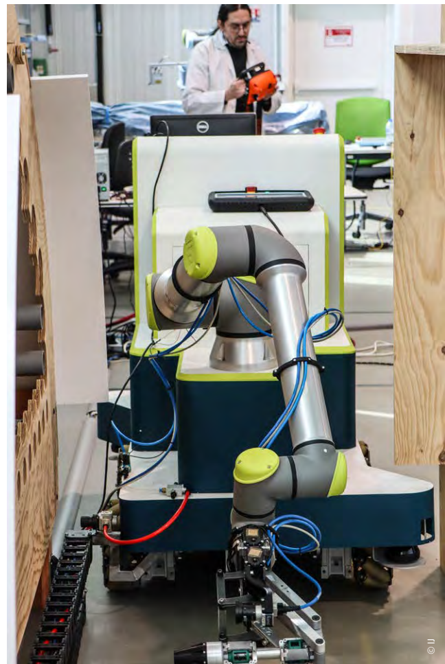
Ludovic Delval, ingénieur de recherches à IRT Jules Verne, en pleine démonstration de “Mascotte”, le robot extracteur de tubes de centrale nucléaire.
